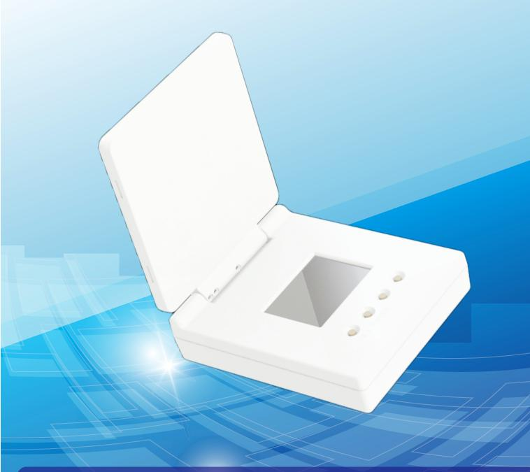
AR-661UG-L為一輕巧便利、簡單操作的手持型 UHF 無線射頻辨 識讀取器,符合ISO18000-6C(EPC GEN2)所有標準協訂。內建2.2吋 LCD螢幕與25dBm射頻模組與天線,透過簡易的操作行為,直接在 LCD螢幕上獲得標籤或是設定的卡號的資料。適合於單一筆資料處理。
